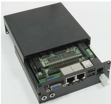
Fig.2. Plataforma de desarrollo basada en fit-PC.
