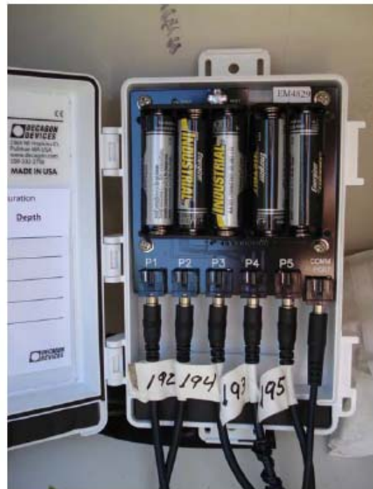
Conexión de los sensores al data-logger (Marismillas cota baja).
