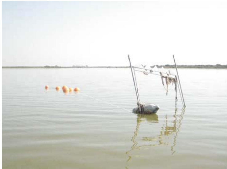
Fig. 4. Detalle del sistema de sensores y fondeo para la monitorización continua de CO 2 en aguas de la laguna de Santa Olalla. En concreto, las coordenadas en las que se ubican los equipos son 6° 28.740 ; 36° 58.644.
