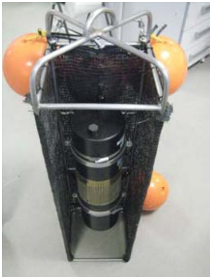
Fig. 4. Detalle del sistema de sensores y fondeo para la monitorización continua de CO 2 en aguas de la laguna de Santa Olalla. En concreto, las coordenadas en las que se ubican los equipos son 6° 28.740 ; 36° 58.644.
