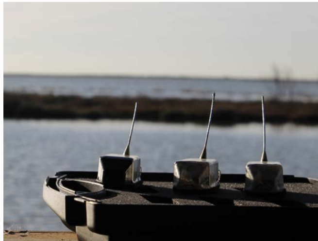
3.- Ejemplo de Prototipos de Emisores de menos de 30g probados en fochas.: UHF, VHF, GPS y GPRS, con batería adicional y carga solar.
